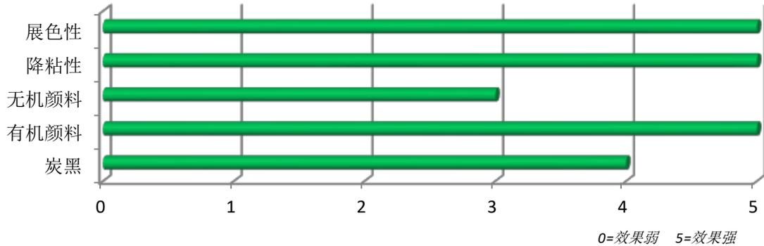
UNIQ<sup>®</sup> SPERSE 630 U 是适用于水性的新型润湿分散剂，适用于各类水性体系并用于分散各类颜料。该产品非常适合用于研磨无树脂色浆。UNIQ<sup>®</sup> SPERSE 630 U 具有非常出色的颜料稳定性，对有机颜料展现出优异的润湿分散性能，展色性，饱和度透明度，改善光泽。同时具有优异的降粘效果，可以提高色浆中颜料的载入量。
