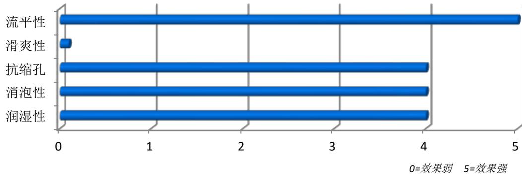
UNIQ® FLOW 360 S 不含硅，能够有效的降低涂料表面张力，提高对底材的润湿性、抗缩孔性。同时，该产品能够完全覆盖底材表面，提供快速润湿和流平，优化漆膜。
