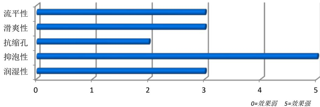
UNIQ® FLOW 430 S 是烷基改性聚硅氧烷流平剂，同时拥有很强的消泡表现，特别适用于无极性至中极性体系。当重涂时该产品能有些防止重影和透印问题。UNIQ® FLOW 430 S 能帮助消光粉的排列定向，避免发花现象。
