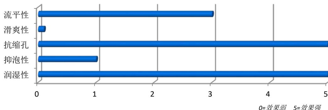
**UNIQ® FLOW 488 U** 可以用于水性体系/油性体系/UV 体系，改善底材润湿。此产品不影响层间附着力，可以用于底涂/中涂/面涂。在水性涂料中，可以应用于 PH 4-9 的范围，低稳泡。此产品是改性有机硅，不会提供滑度和耐划伤性能。
