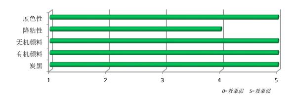
UNIQ®SPERSE 605 S 是溶剂型体系用润湿分散剂,适用于汽车涂料、工业涂料和颜料色浆。在 2KPU、烤漆体 系和 CAB 体系,该产品展现出优异的降低研磨浆粘度的能力。它在不同的颜料体系中都展现了卓越的透明性。对 于高色素炭黑, 能够带来杰出的黑度及兰相。
