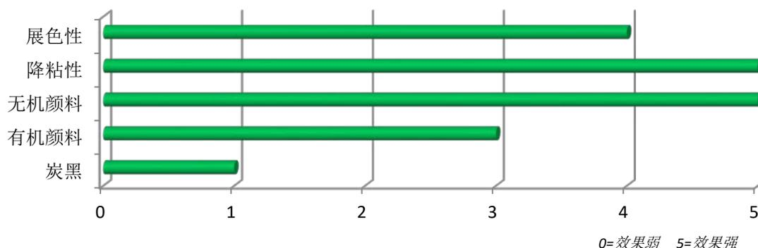
**UNIQ<sup>®</sup> SPERSE 745 S** 是用于溶剂型体系的润湿分散剂，适合用于工业涂料、建筑涂料和防腐涂料体系。对无机颜料、有机颜料或膨润土有杰出的分散性能，能够有效降低粘度，防止沉降，从而可以提高颜/填料在研磨配方中的载入量。同时可以提高透明度和遮盖力。
