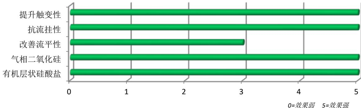
**UNIQ<sup>®</sup> SPERSE P-405** 是用于乙烯基酯、环氧树脂的液体流变助剂，在不饱和聚酯和胶衣等塑料应用中能够有效增强气相二氧化硅或有机层状硅酸盐（有机粘土）的流变性能，使气相二氧化硅/有机粘土更易加入，防止分层，同时能够增加或稳定触变行为。
